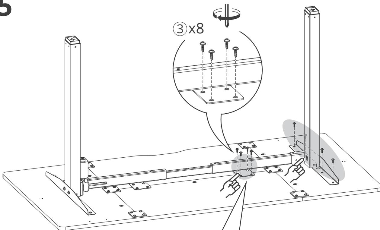
**i** 注記: フレームの取り付け穴が、天板の穴とそろうように配置してください。
